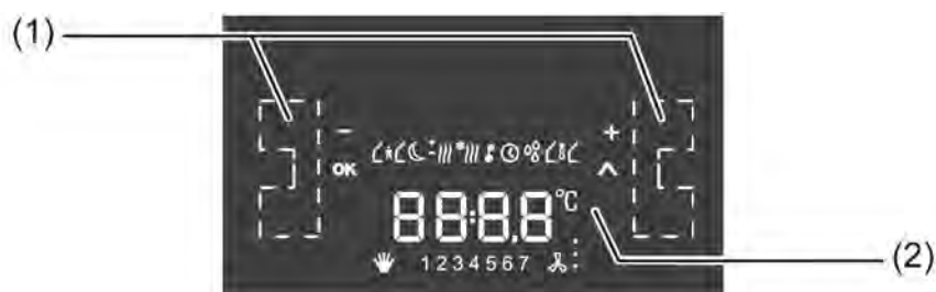
Bild 49: Gerätedisplay und Displaytasten
